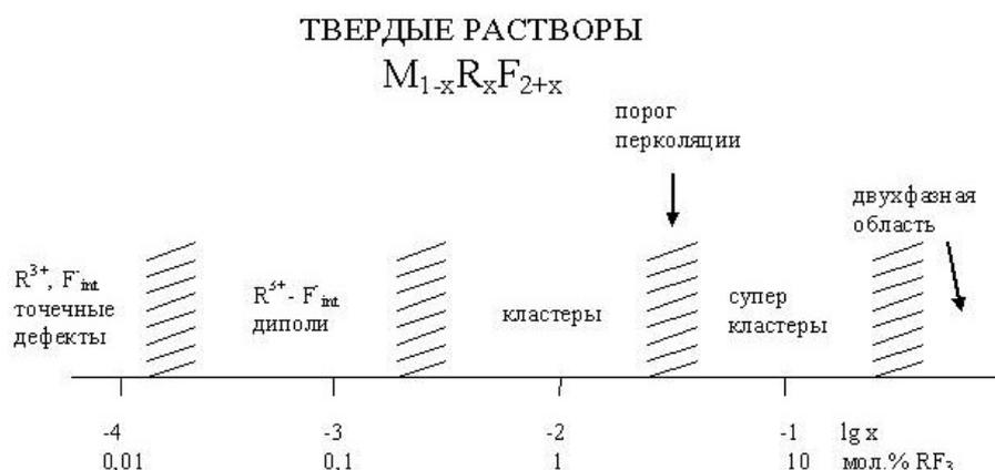
РИС. 2. Схема последовательной ассоциации дефектов в структуре твердых растворов  $\text{M}_{1-x}\text{R}_x\text{F}_{2+x}$
