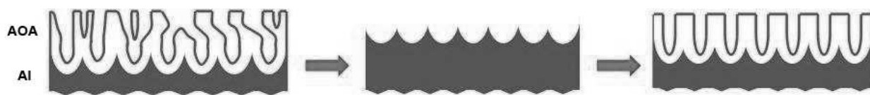
Рис. 5. Схематическое изображение двухстадийного процесса анодирования Al . Слева направо: плёнка АОА после первой стадии анодирования; удаление пористой плёнки; плёнка АОА после второй стадии анодирования [74].
