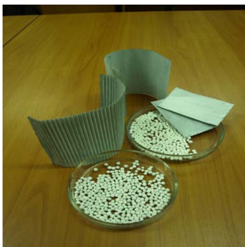
РИС. 1. Внешний вид образцов катализатора в виде сферических гранул, гладкой и гофрированной пластин
