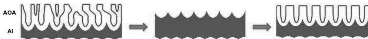
Рис. 5. Схематическое изображение двухстадийного процесса анодирования Al. Слева направо: плёнка АОА после первой стадии анодирования; удаление пористой плёнки; плёнка АОА после второй стадии анодирования [74].
